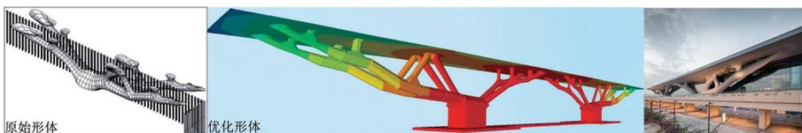
图10：基于渐进结构优化的卡塔尔会议中心
