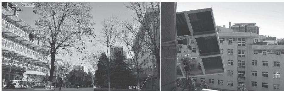
图 1: 笔者开展的利用“智能镜面”为建筑自动提供日照的实验场景
