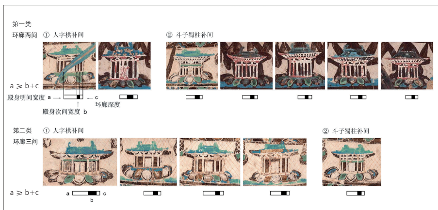
图13：初唐莫321窟北壁宝树观所绘殿身三开间角部一柱殿的立面比例分析
