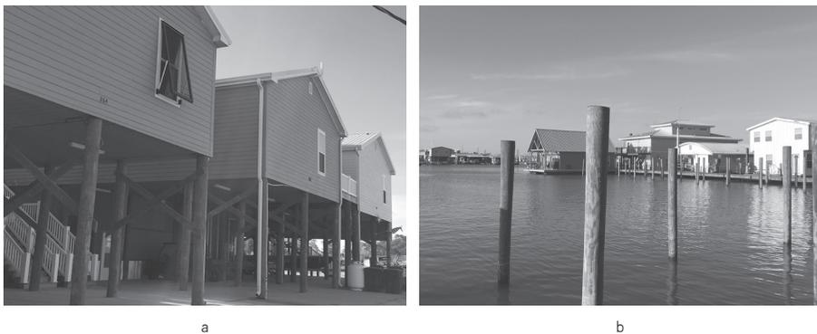
图2: 威尼斯, 路易斯安那州, 美国, 被高高架起的新建房屋(a)以及水面上有着浮力基础的房屋(b)
