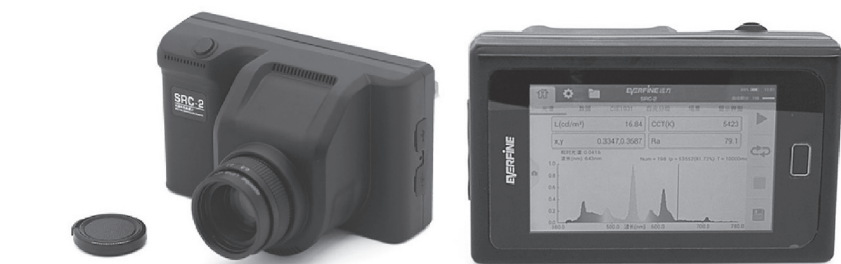
图7: 测量设备, SRC-2光谱彩色亮度计
