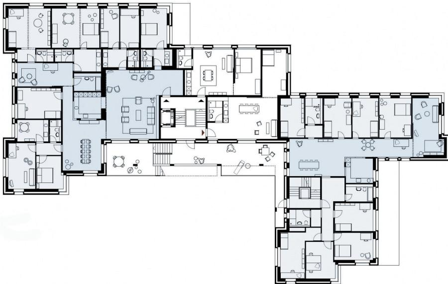
图15：集群住宅的平面——苏黎世住宅合作社“发电厂2”住宅合作(Kraftwerk 2, 2008—2012)。图中浅灰色为带卫浴设施的公寓单元，深灰色为共用餐厅与公共厨房
