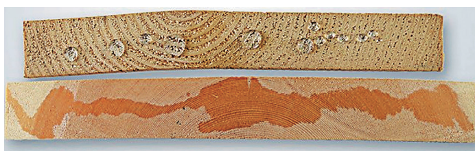
图10: 纳米硅酸盐材料处理过(上)与未处理过的木材(下)防水能力对比
