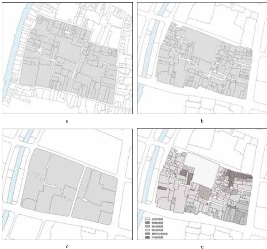
图3: 小西湖街区地块格局(a.1936年地籍图; b.2016年用地红线权属范围图; c.2017年控制性详细规划中的地块划分; d.地块变化模式分类)
