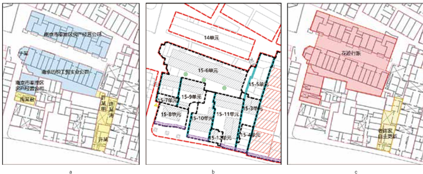
图10: 微更新实施单元的拆分与合并 (a.2016年地块产权归属; b.14、15号规划管控单元图则局部; c.实际实施范围)
