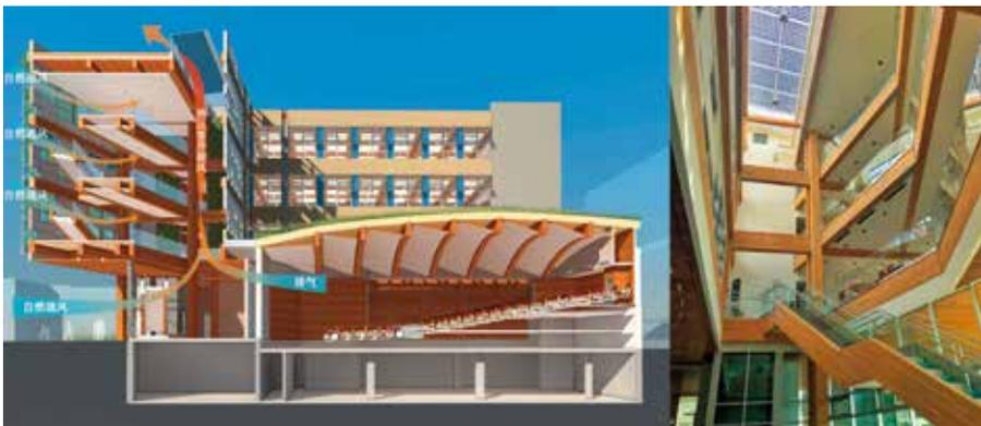
图10: CIRS中热压竖井的拔风效应
