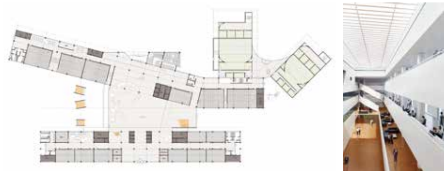
图8: 公共教学楼内廊式平面布局示意
