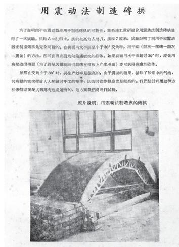
图 1b: 振动法制造砖拱
