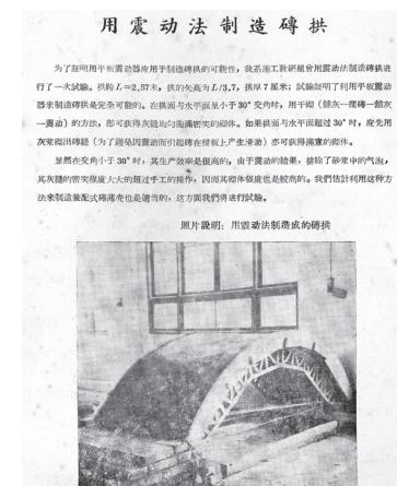
图 1b: 振动法制造砖拱
