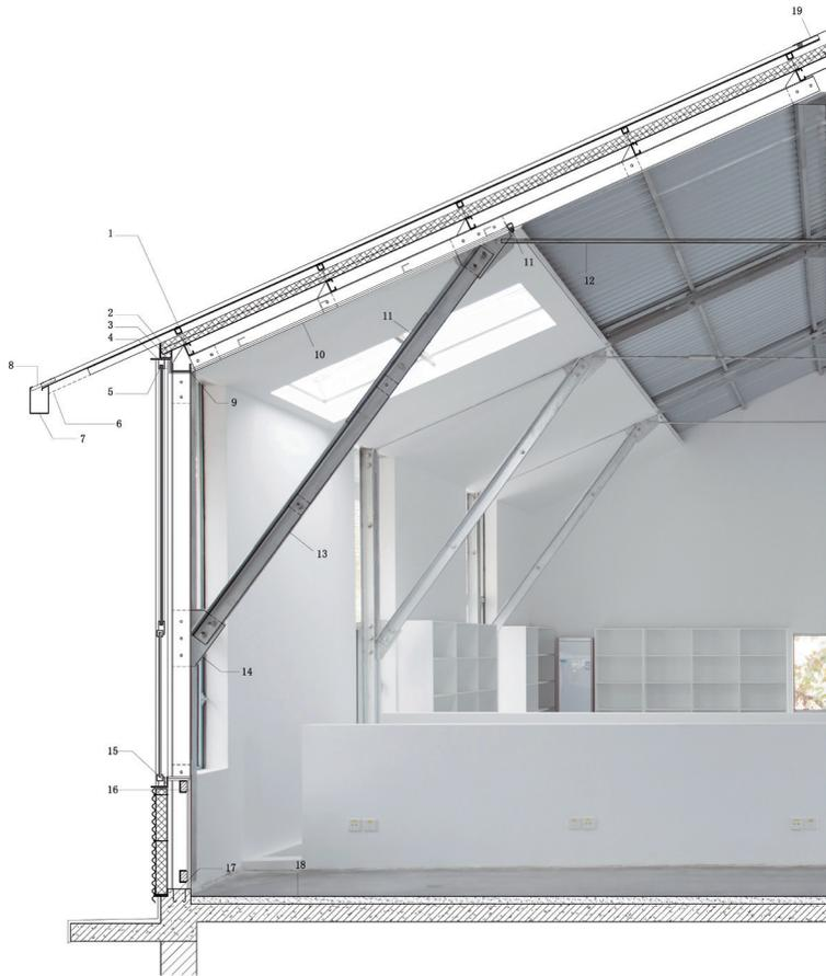
图6: 圈梁作为一层砖墙压顶同时和二层钢结构交接
