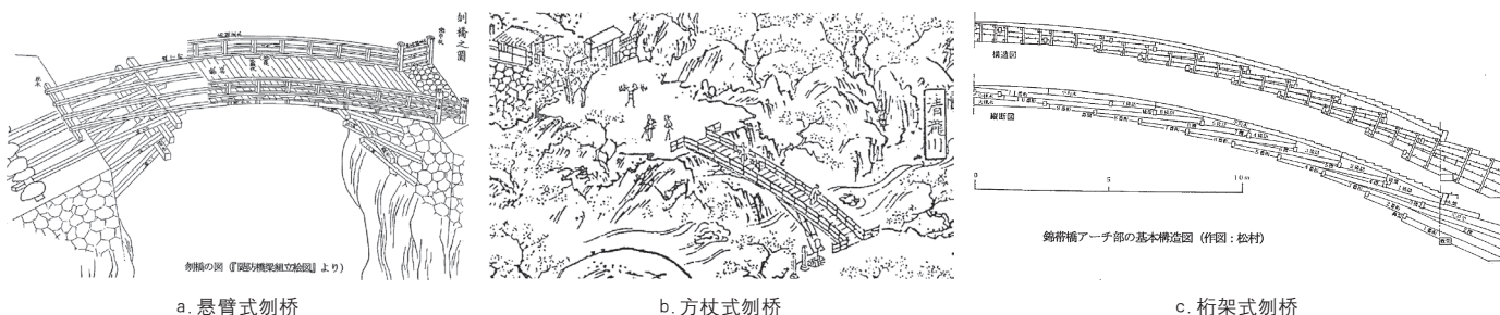
图 6: 日本刳桥的结构形式
