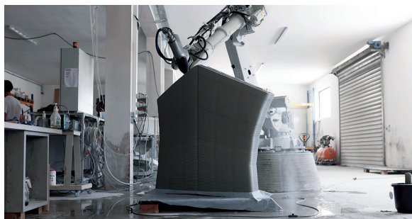
图 14: 2021 年 Striatum 人行天桥混凝土砌块三维打印
