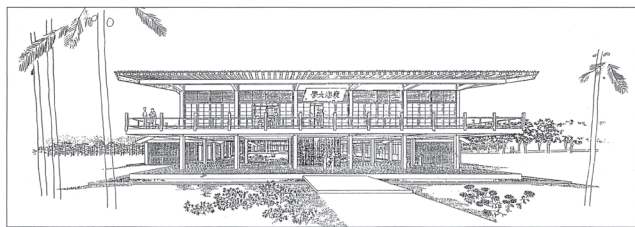
图3: 东海大学一期校舍剖透视图(张肇康设计, 1955年), 以质朴的材料本色、暴露的建筑结构、洗练的细节设计呈现建筑之美, 体现了结构理性视角下的现代中国建筑探索思路
