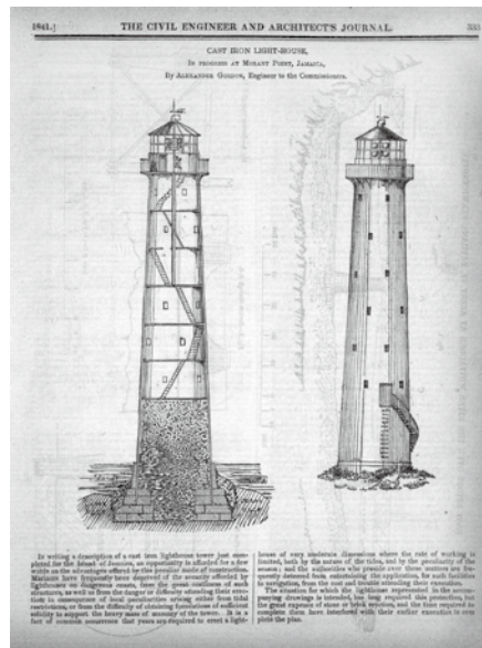
图 4: 1841 年英国在牙买加首次使用组装预制构件方法建设的莫特兰角灯塔
