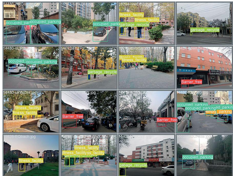
图5：半监督 YOLO V8 模型检测结果示意图
