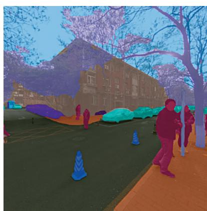
图 2. Mask2former 分割模型在社区全景图像中的处理效果
