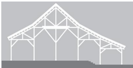
图 2: 根据 1987 年建成方案,何陋轩的纵剖面(结构立面)剖切于主屋面下的边跨位置(图片在 2023 年保护修缮方案的竹桁架剖面基础上,补充线条示意)
