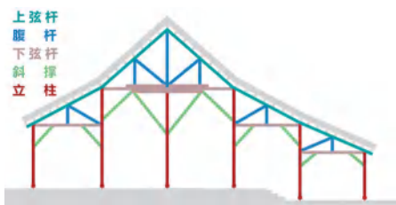
图25：根据1987年建成方案，图示构件的名称与位置
