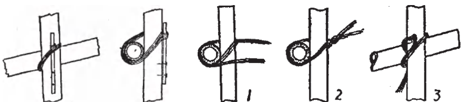
图 5: 绑扎式做法竹结构的两种方式:左为麻绳绑扎;右为竹篾绑扎
